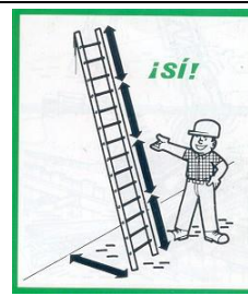
VIGILAR QUE LA SEPARACION DEL PIÉ DE ESCALERA, DE LA SUPERFICIE DE APOYO, SEA LA CORRECTA.
